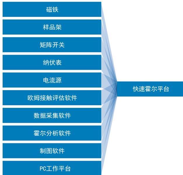
Lake Shore FastHall的M91集成了电压表、电流源、矩阵开关、数据采集软件、欧姆接触检查软件、霍尔分析软件。购买了快速霍尔效应测试选件后，用户可以使用永磁铁探针台得到样品的霍尔电压、电阻率、霍尔系数、迁移率、载流子浓度/类型/密度。
